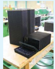
▲金型から成形された製品一つずつに切り分け検品を行う▶
