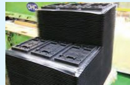
▲金型から成形された製品一つずつに切り分け検品を行う▶
