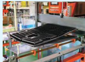
▲機械で成形し切り分けていきます
