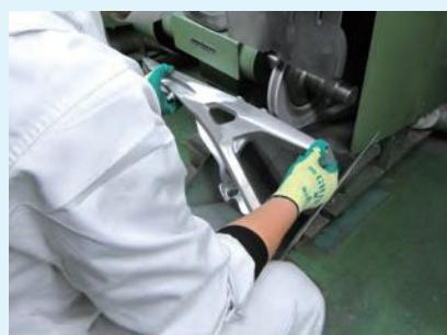
◀ 研磨作業 主に手作業で加工を行います。研磨仕上げから鏡面仕上げまで、様々な加工が可能です！
