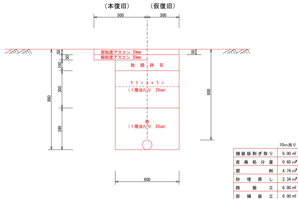
配水管標準掘削断面図
