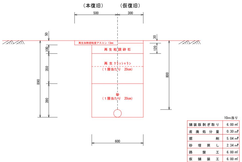
配水管標準掘削断面図
