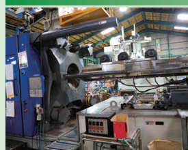
▲樹脂を溶かし金型へ圧力をかけて流し込み成形します
