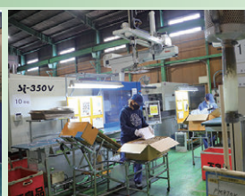
▲成形後、検査や組み立ての工程へ送ります
