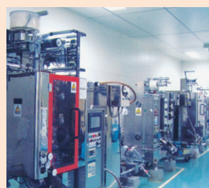
▲自動充填ライン (ミニバック・ミディアムバック)
