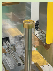
▲円筒ケース成型機 筒の底部分を取り付けます。
