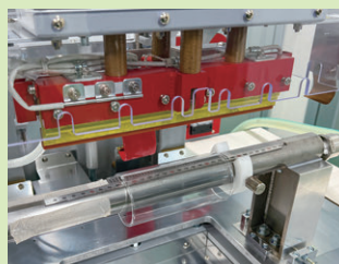
▲円筒ケース成型機 シートを筒状に加工します。
