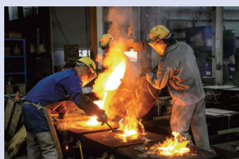
砂型に溶かした材料を入れ成型。
