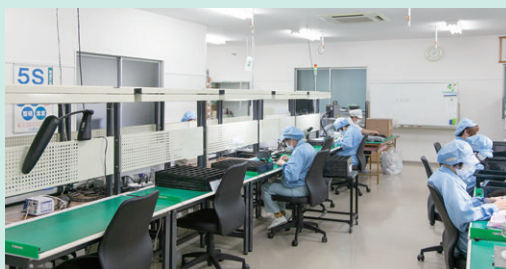
1番小さいもので4mmのマイクロホンにリード線やプラグコードを取り付ける作業をおこないます。
