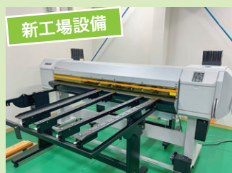
▲大判インクジェットプリンター 円筒ケースになる前のシートに印刷します。
