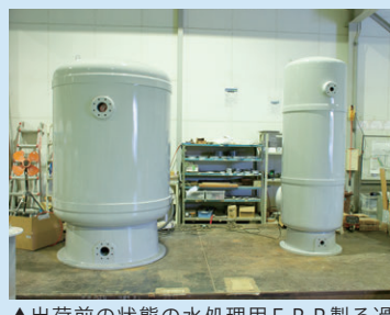
▲出荷前の状態の水処理用FRP製ろ過タンクです。
