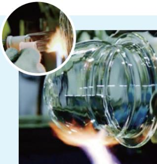
硝子旋盤加工
