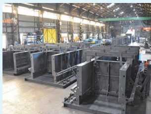
鋼製型枠製作
