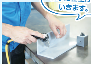
塩ビ溶接 塩ビ管や塩ビプレート溶接して様々な形状の製品を生産します
