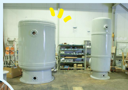
出荷前の状態の水処理用FRP製ろ過タンクです。
