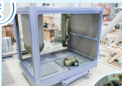
小型ユニット式ろ過機本体のケースです。この後、配管ポンプ等の取付組立作業に移ります。
