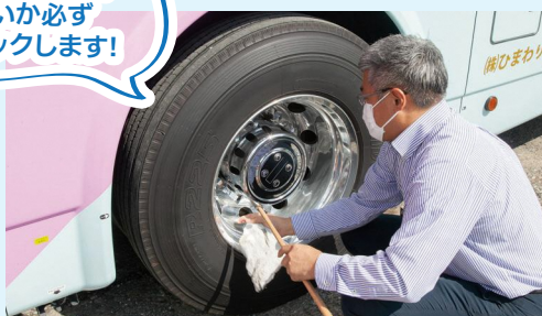
出発前には必ずボルト部分を確認するなどタイヤ、足回りをチェックします。他にもエンジンルームなどのチェックも欠かしません。
